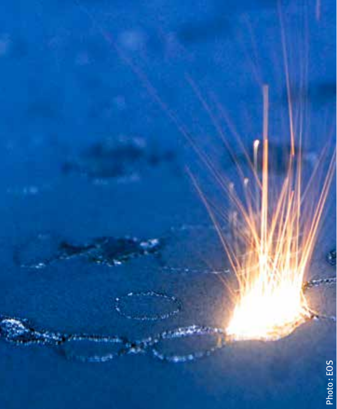
Procédé de frittage laser (DMLS) utilisé pour les ponts et couronnes dentaires.
